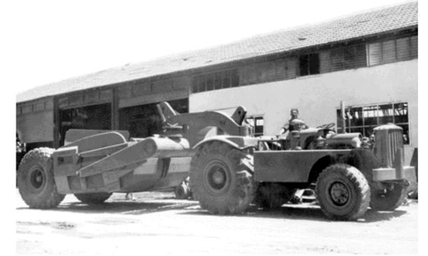
Un scraper tracté par Caterpillar DW 10 devant l'usine d'Inkermann (1948)
