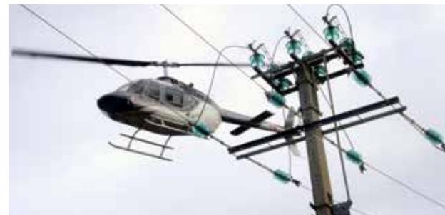
À partir de 2018, GÉRÉDIS surveille le réseau des lignes moyenne tension (20 000 volts) du département par des survols en hélicoptère équipés de la technologie Lidar ou *Light Detection and Ranging*, un appareil de télédétection (mesure de distance) par laser.
